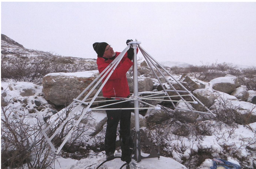
Abbildung 1: LWA-Antenne, montiert auf einem Felsen. Rentiere sollen die Antenne nicht als Kratzbürste missbrauchen. Die Gewindestangen zur Befestigung der Montierung wurden mit speziellem, kältetauglichem Kleber in vorgebohrte Löcher im Felsen eingeklebt. Bei -20^{\circ}\text{C} ist die Bastelei an der Antenne für den Autor gewöhnungsbedürftig und nicht trivial.
