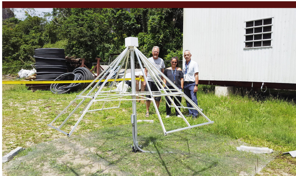
Abbildung 2: Langwellen-Antenne (Long Wavelength Antenna LWA) zum Empfang der solaren Radiostrahlung im Bereich 15-120 MHz. Im Hintergrund (mit verdecktem Bauch) der Autor, die Projektleiterin Dr. Alessandra Abe Paccini und der Instrumenten-Ingenieur Alfredo Santini .
