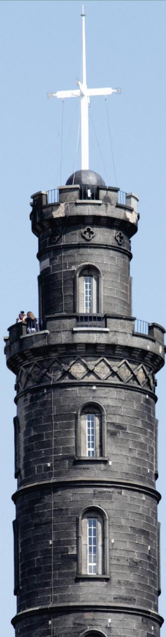
**Abbildung 3:** Durch ein elektrisches Signal aus der Sternwarte wurde der Fall des Zeitballs an der Spitze des Nelson-Monuments jeden Tag genau um 13:00 Uhr automatisch ausgelöst. Im Hafen von Leith konnten die Schiffsbesatzungen damit ihre Chronometer genau justieren. Der Zeitball befindet sich hier in der unteren Position.
