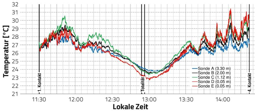
**Abbildung 2:** Der Temperaturverlauf während der totalen Sonnenfinsternis am 21. August 2017 bei Stapleton, NE, USA. x-Achse: Lokalzeit (UTC-5 Std); y-Achse: Temperatur (°C). Um die Totalität herum sind alle Messkurve gültig (s. Text). Die grüne Messkurve ist erst ab 13:35 Uhr gültig. Die schwarze Messkurve ist nach der Totalität gültig.
