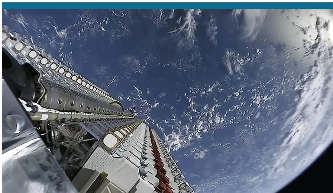
**Abbildung 1:** Zwei Stapel mit insgesamt 60 Starlink-Satelliten auf einer Falcon-9-Oberstufe
