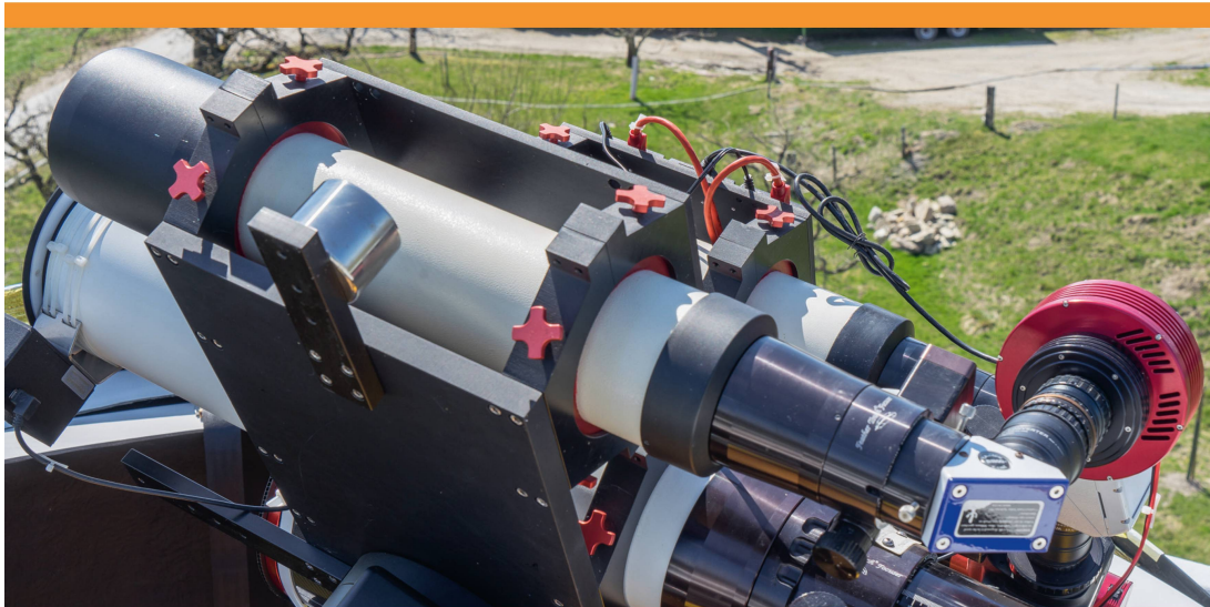
Abbildung 2: TeleVue NP-101 Refraktor des Sonnenturm Uecht in Niedermuhlern. Lunt Ca II K Diagonal Filtermodul mit einer Halbwertsbreite von 0.24 nm. Atik 4000 CCD-Kamera mit einem Sonnendurchmesser von 1'900 Pixeln und einer Auflösung von 1.0 Bogensekunden pro Pixel.
