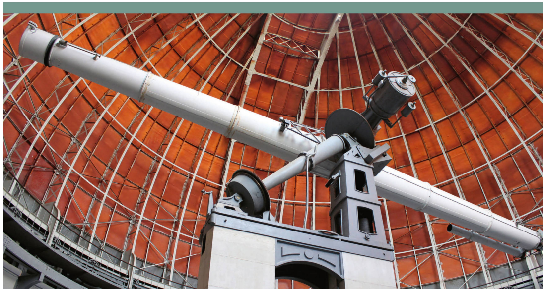
Abbildung 4: Das Grand Équatorial von Nizza zählt mit einer Brennweite von 18 Metern weltweit zu den grössten Refraktoren. Die von den Brüdern Paul und Prosper Henry geschliffene Optik hat einen Durchmesser von 76 Zentimetern. Dank seiner hohen Auflösung ist das Objektiv besonders gut geeignet für die Beobachtung enger Doppelsterne.
