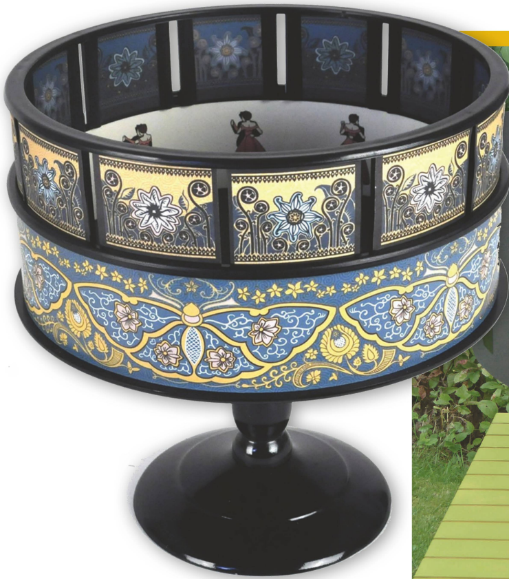
Abbildung 6: Diese Maschine mit dem Namen Zootrop oder auch Wundertrommel erzeugte u. a. die ersten bewegten Bilder. Man blickt bei drehendem Zylinder durch die vorbeisauenden Sehschlitze und sieht so für einen kurzen Augenblick jeweils die gegenüberstehenden Bilder – bei jedem nächsten Schlitz das nächste Bild. So entsteht ein bewegtes Bild, das sich nach jeder Umdrehung wiederholt.
