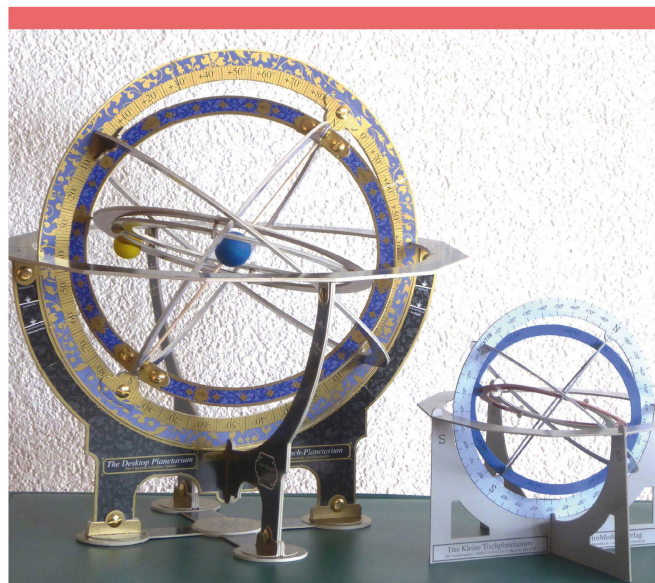
Abbildung 7: Das kleine und das grosse Tisch-Planetarium von AstroMedia. Das grosse Modell enthält – von aussen nach innen – fest stehend den Horizont (waagrecht), senkrecht dazu den Meridianring (für alle geogr. Breiten einstellbar); um die Himmelsachse drehbar zwei Ringe der Himmelkugel, darin die 23.5^\circ schief liegende Ekliptik mit der Mondbahn, deren Knoten verschiebbar sind. Sonne, Mond und Planeten aus geschlitzten Moosgummikugeln können an passender Stelle auf die Ringe gesteckt werden.
