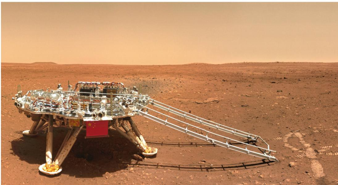
**Bild: Die Landeplatt- form mit ausgefahrener Rampe, über welche der Rover Zhurong den Marsboden erreicht hat.**
