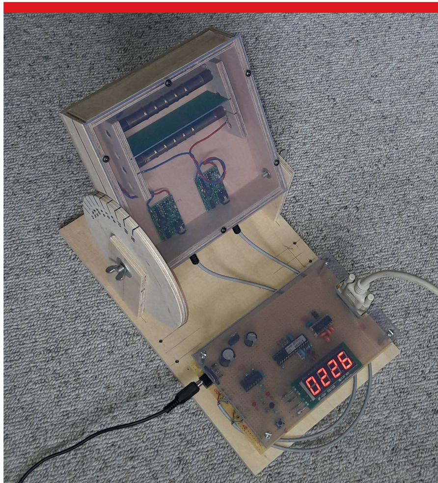
Abbildung 2: Der Cosmic-Rays-Detector mit 2 alten sowjetischen Geiger-Müller-Zählrohren (Bild: Peter Hirt)
