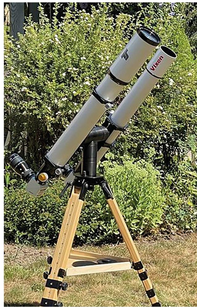
**Abbildung 3:** Zwei azimuthal montierte langbrennweitige Fraunhofer Refraktoren auf einem Hartholzstativ. Für die Sonnenbeobachtung wurden beide Refraktoren mit einem Helioskop ausgerüstet und mit einem Weitwinkelokular mit einer Vergrößerung um 64 versehen.
