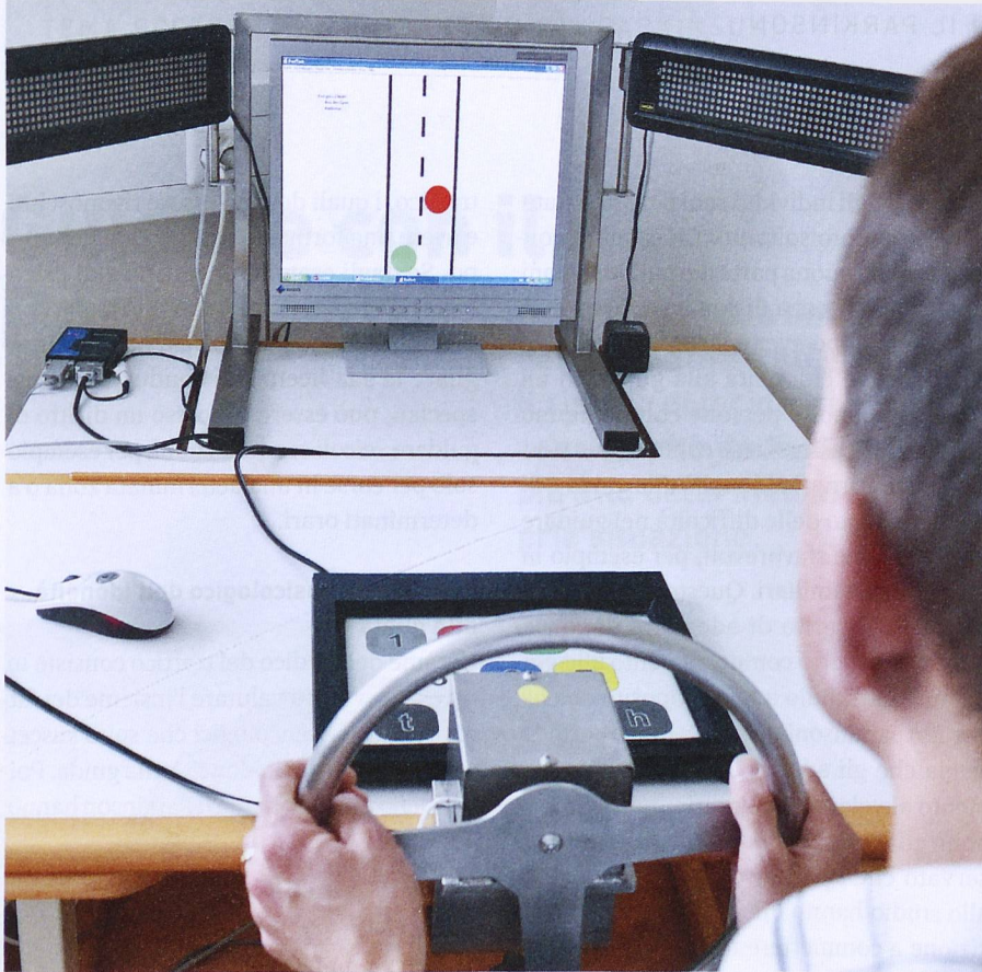
Sistema per testare l'idoneità alla guida: l'utente deve rimanere entro i limiti della corsia e al contempo evitare le collisioni. Foto: Kurt Heuberger
