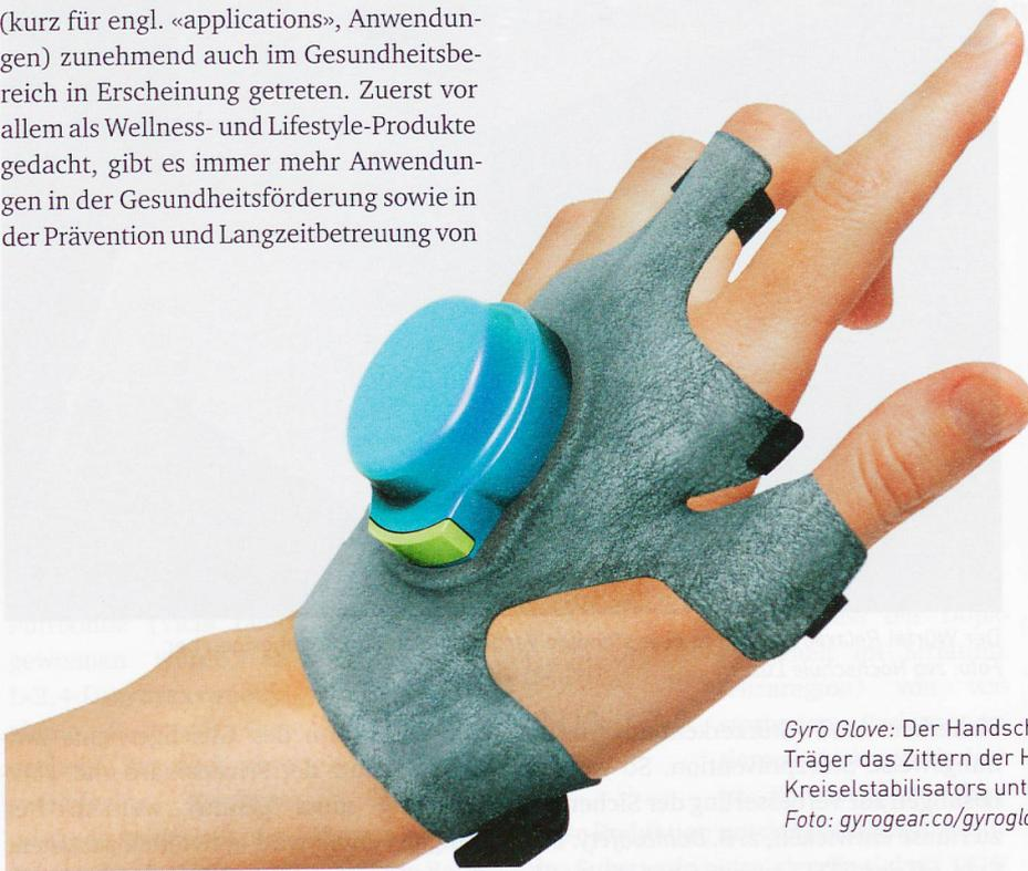
*Gyro Glove*: Der Handschuh soll beim Träger das Zittern der Hand mithilfe eines Kreiselstabilisators unterdrücken.
