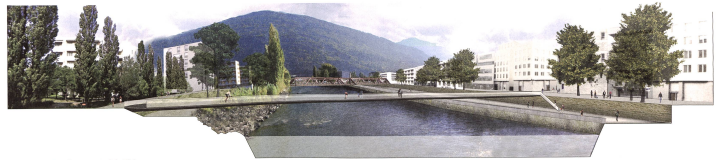
Coupe-perspective: bras principal du Rhône Ein treue gräbliche Digue rekonstruiert in Terrassen à Vissigen, ein treu neues quartier urbain sur l'île Rhône. Schütt/Rheineufer: Hauptarm der Rhône Linkes Rheineufer: Erhöhter und terrassenförmig gebauter Damm in Vissigen. Rechtes Rheineufer: Neues Stadtviertel auf Flussinsel
