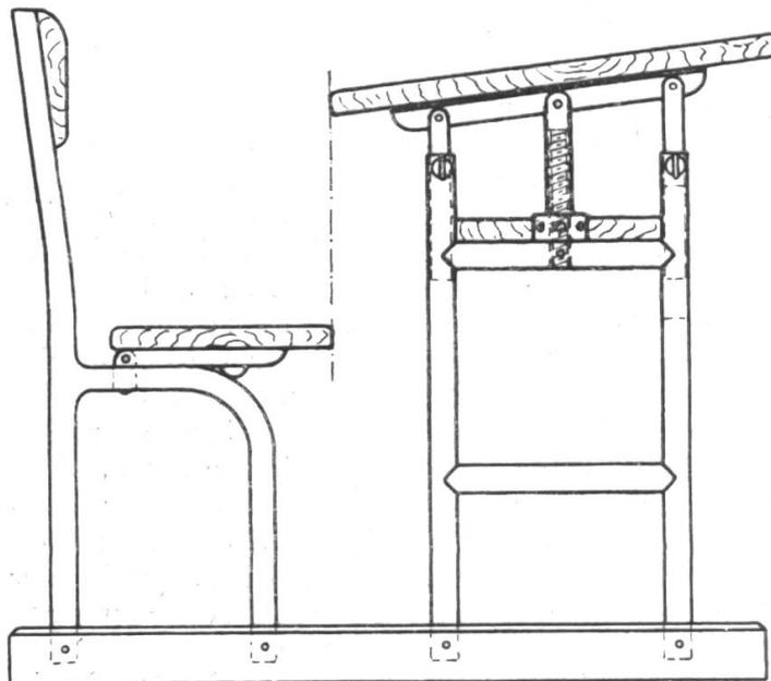
Der Tisch Nr. 1 wird in zwei Dimensionen hergestellt. Die Höhe desselben ist veränderlich, und die Platte nach Belieben schräg verstellbar, was durch gut ausgedachtes Ineinanderschieben der Röhren bewerkstelligt wird.
