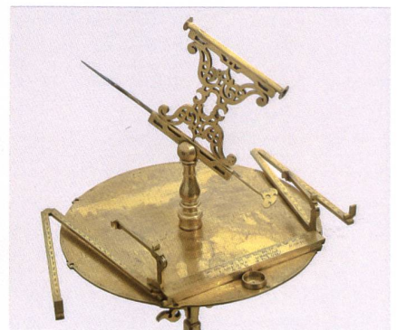
Fig. 35 Le perspectographe curviligne de l'ingénieur militaire Baldassare Lanci (1510-1571), 1557, laiton doré, Ø 30 cm, H avec support 139 cm (Florence, Museo Galileo, inv. 152, 3165). – Sur cette variante du perspectographe, qui est aussi l'un des plus anciens conservés, on fixait la feuille au bord du plateau, en demi-cercle. En 1583 déjà, dans ses «Deux règles de la perspective pratique de Vignole», le mathématicien et cosmographe dominicain Egnatio Danti démontra l'inexactitude des perspectives dessinées avec ce type d'instrument.
