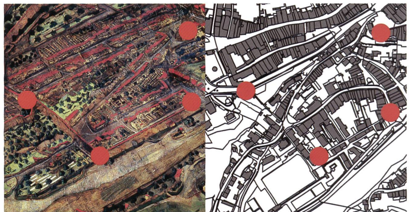
Fig. 23 Jalons de triangulation des quartiers de la Grand-Fontaine et de la Neuveville (Vue de Grégoire Sickinger et cadastre actuel). – L'Hôtel de Ville et les trois angles de l'enceinte de la Neuveville forment un trapèze presque isocèle. Les légères déformations du dessin par rapport au plan cadastral sont à nouveau perceptibles sur le haut.
