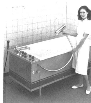
**Medizinalbad-Kombination:** ● Gehäuse 2 mm Anticorodal für hohe Stabilität ● Wanne Stahlblech, säurebeständig, weiss emailliert oder Chromnickelstahl 18-8-2 ● Gehäusefarbe nach Ihrer Wahl ● eingebaute Kohlensäure-Imprägnierarmatur ● auf Wunsch, eingebaute Sole-Dosiervorrichtung mit elektronischer Wähltastatur ● kompakte Abmessungen: 200 x 80 cm
