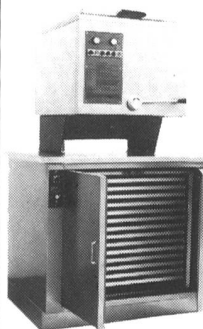
Abbildung zeigt 60 Liter Rührwerk mit Wärmeschrank
