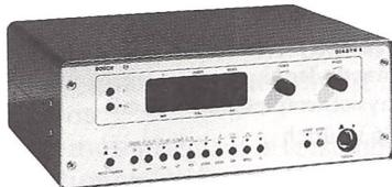
Mikroprozessorgesteuertes Reizstromgerät mit diadynamischen Stromformen nach Bernard. Vorwahlmöglichkeit von 2 Behandlungszeiten.
