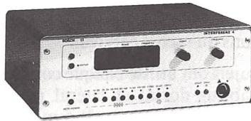
Mikroprozessorgesteuertes Reizstromgerät mit Interferenzströmen nach Nemeo. Vorwahlmöglichkeit von 2 Behandlungszeiten.
