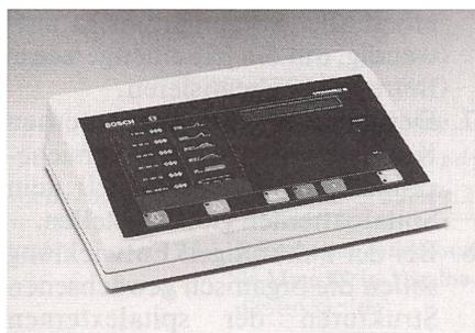
neue Saugmassagegerät VACOMED D angeboten. Es bietet die Saugmassage durch kontinuierlichen oder gepulsten Unterdruck in stufenlos einstellbarem Impulstakt und zeichnet sich durch besonders ruhigen und vibrationsarmen Betrieb aus. Der vor der Vakuumpumpe angeordnete Wasserabscheider verhindert ein Verschmutzen der Pumpe. Die 2 Saugelektroden ermöglichen eine schnelle und einfache Reizstromapplikation. Lassen Sie sich vom Preis angenehm überraschen.
