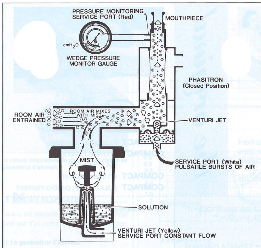
Fig. 4: Phasitron fermé, aspiration par le venturi.
