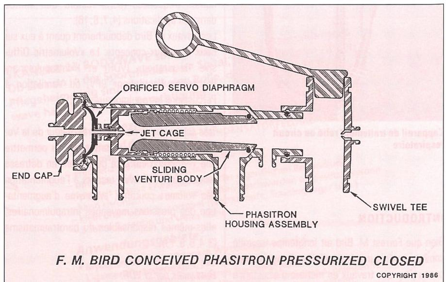
Fig. 3: Phasitron en position fermée.
