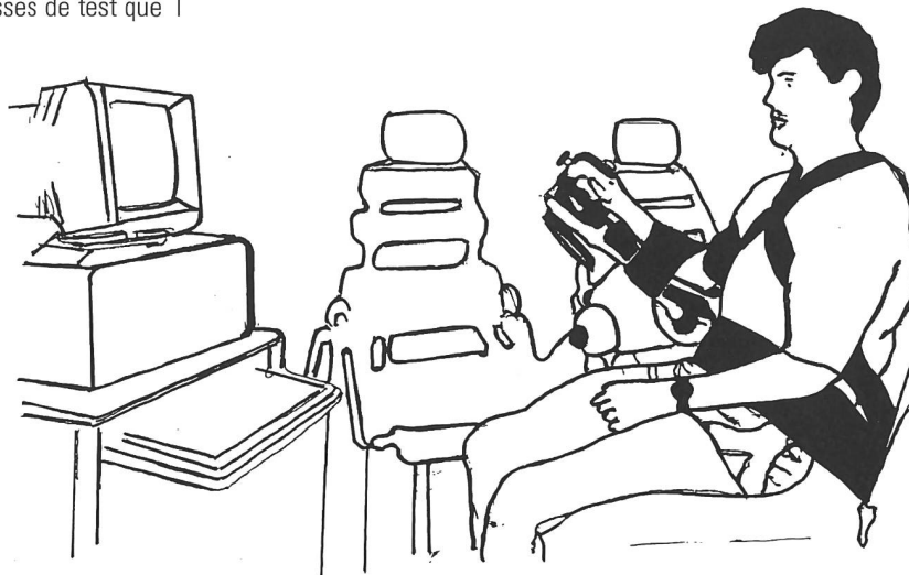
Fig. 1: Notre position: assis, bras en abduction à 45°, dans le plan de l'omoplate.
