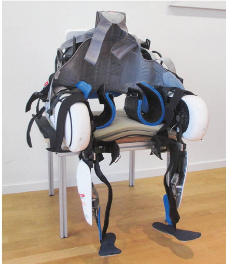
Das Exoskelett wiegt 35 Kilo, alltagstauglich ist es noch nicht. | L'exosquelette pèse 35kg, il n'est pas encore adapté à la vie de tous les jours.
