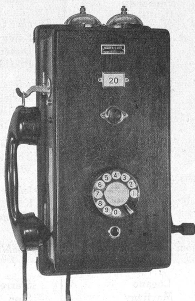
Abb. 1. Selektor-Telephonapparat für dezentralisierte Wechselstromwahl.
