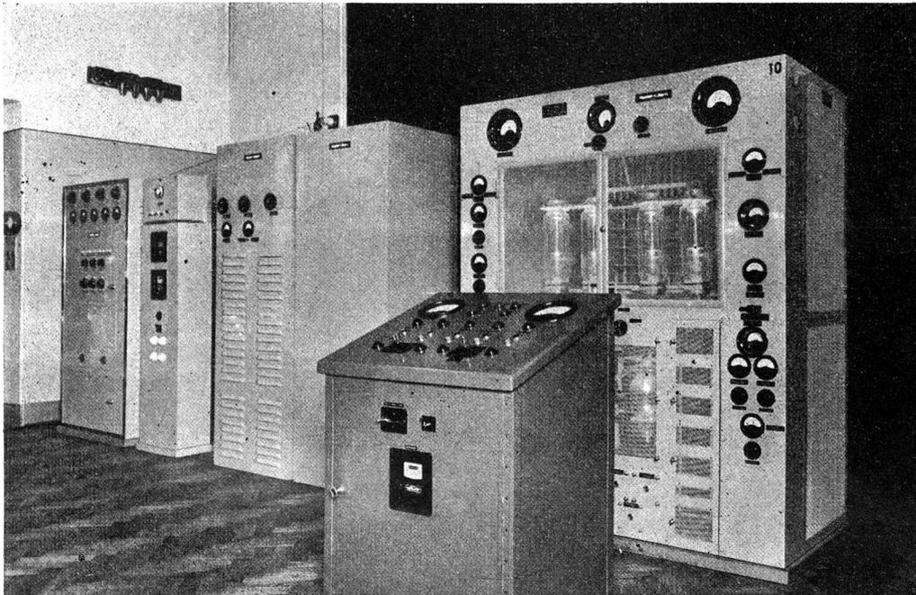
Sender für den drahtlosen Flugsicherungsdienst und für drahtlose Übersee-Telegraphie
