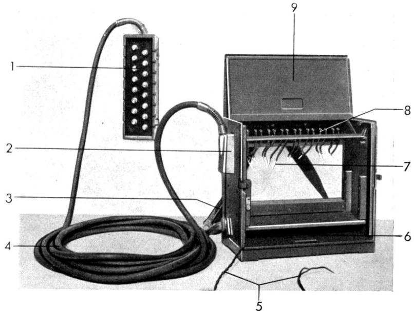
Hier ist auch das Anschlusskabel für den Abfrageapparat. Die Anschlußschiene ist mit der Steckdose links am Kastenrand verdrahtet. Steckdose, Stecker und Zuführungskabel sind  $8 \times 2$ adrig. Das 12 Meter lange Zuführungskabel endigt an einem Kabelendverschluss (Verteiler). Dieser hat die notwendigen Anschlussklemmen und kann durch spezielle Aufhängenvorrichtungen senkrecht oder wagrecht angebracht werden.
