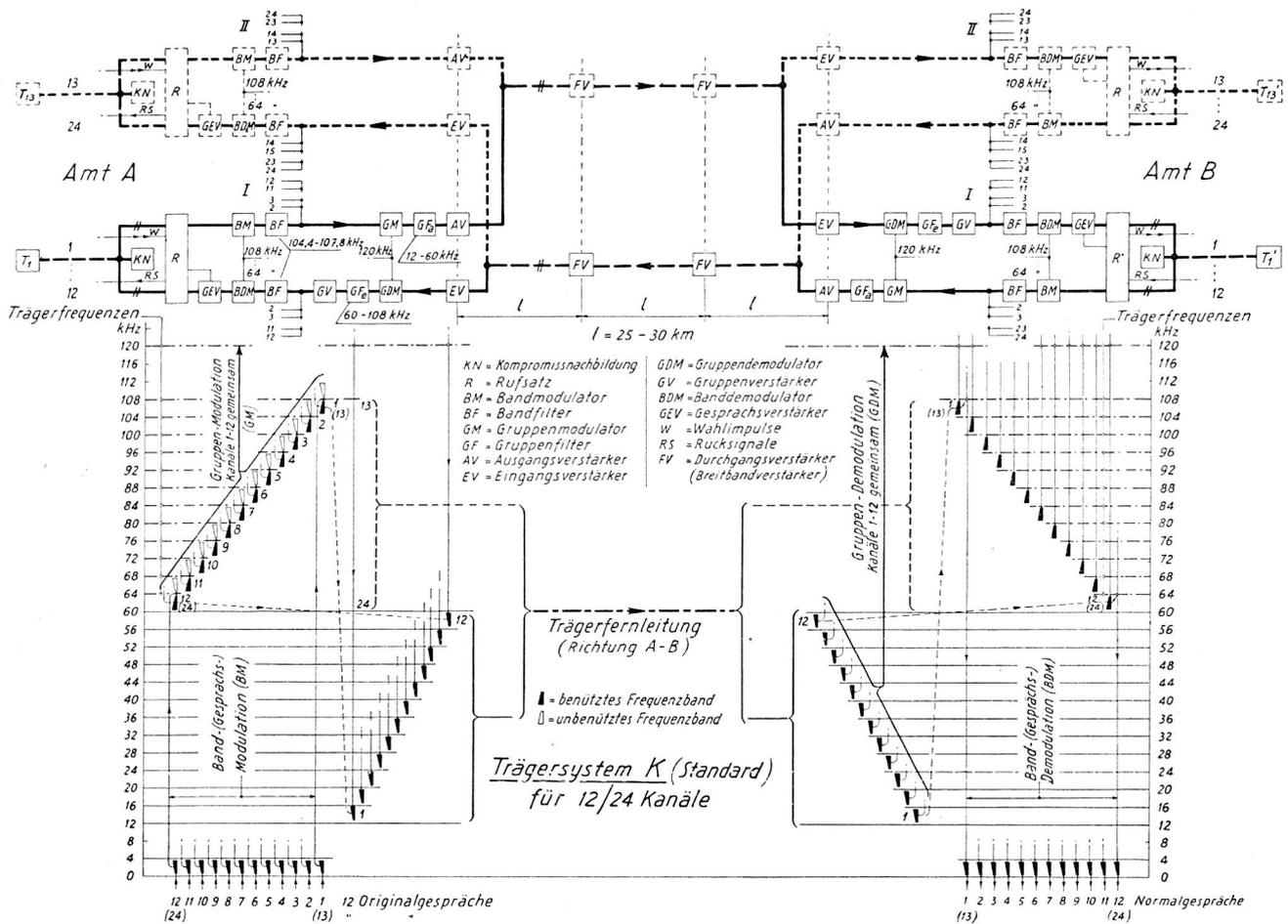
Abb. 3. Schaltprinzip und Modulationsschema einer Trägertelephonanlage für 12/24 Sprechkanäle.
