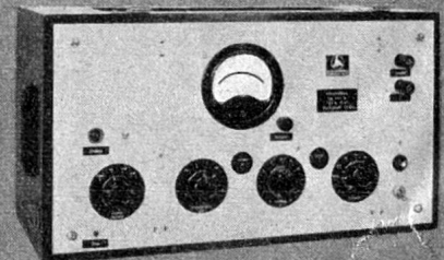
Breitband-Messverstärker (Verstärker-Röhrenvoltmeter) eignet sich für Effektivwertmessung im Frequenzbereich von 10 Hz ... 500 kHz
