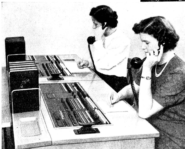
Neue schnurlose Vermittlungseinrichtung mit Zahlengeber für Telephonanlagen mit 20 Amtsleitungen.
