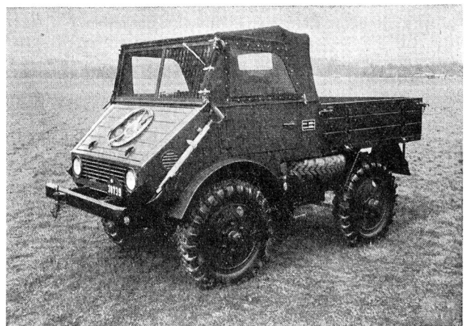
Abb. 1 UNIMOG Mercedes-Dieselmotor, Nutzlast 1,1 t, 6 Vorwärts- und 2 Rückwärtsgänge
