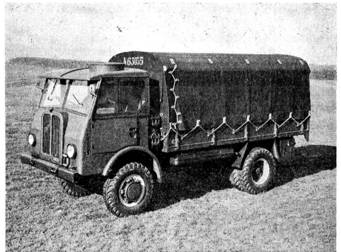
Abb. 3 Geländelastwagen 5 t — 4x4, Saurer Dieselmotor, Nutzlast 5 t
