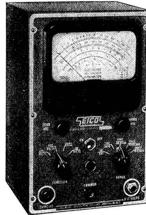
**Röhrenvoltmeter zum Selbstbau «Eico 221»**
