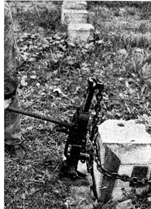
**SIMPLEX-Winden** sind sehr sparsam im Gebrauch, da praktisch **kein Verschleiss**; eine Anschaffung reicht für **1-2 Generationen**. Die **SIMPLEX-Universalwinden** sind die einzigen Winden des Weltmarktes, die ein **Einstückganzstahlrippengehäuse** und eine **bewegliche Fundamentplatte mit Rippen** besitzen. Ihr Gehäuse weist weder **Bolzen, Schrauben, Muttern, Nieten, Stifte** noch **Schweissnähte** auf.
