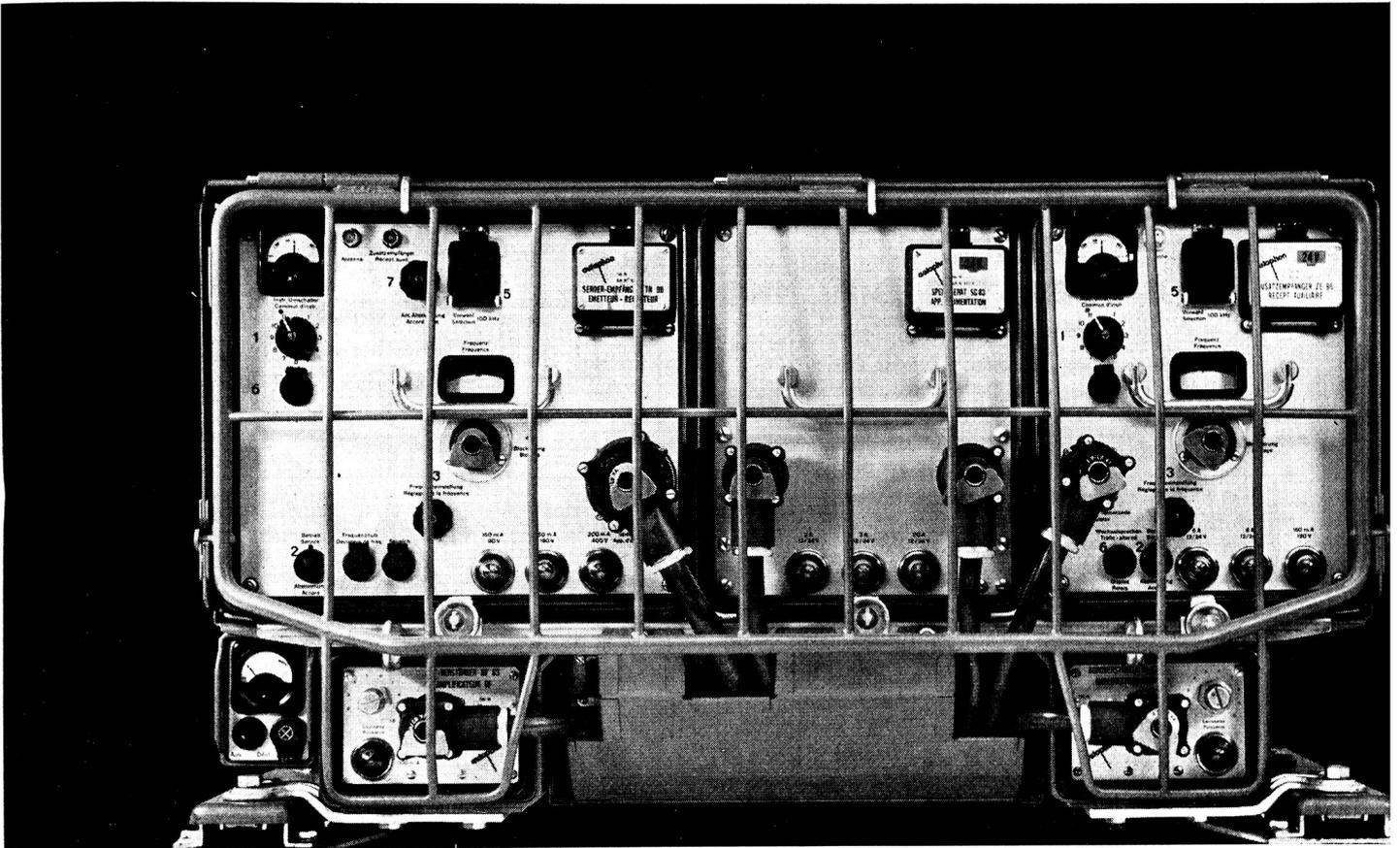
Die Funkstation SE 407, von der Autophon AG für die Schweizer Armee entwickelt, ist für den Einsatz in Panzern, Kdo-Fahrzeugen, Werkstattwagen usw. gebaut. Sender-Empfänger und Zusatzempfänger sind je für mehr als 100 Kanäle ausgerüstet, von denen sich mehrere vorabstimmen und über das Bedienungsgerät fernauswählen lassen. Speisung aus der Fahrzeugbatterie. Die Anlage ist robust und betriebssicher konzipiert, sie wird im Wechsel- oder Gegensprechverkehr und als Relaisstation eingesetzt.
