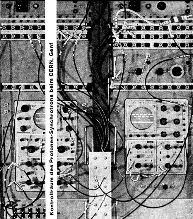
HF-Kabel nach international gebräuchlichen Normen und Prüfvorschriften mit Polyäthylen- und Teflon-Dielektrikum. Spezialausführungen mit  $\pm 2\%$  Toleranz.
