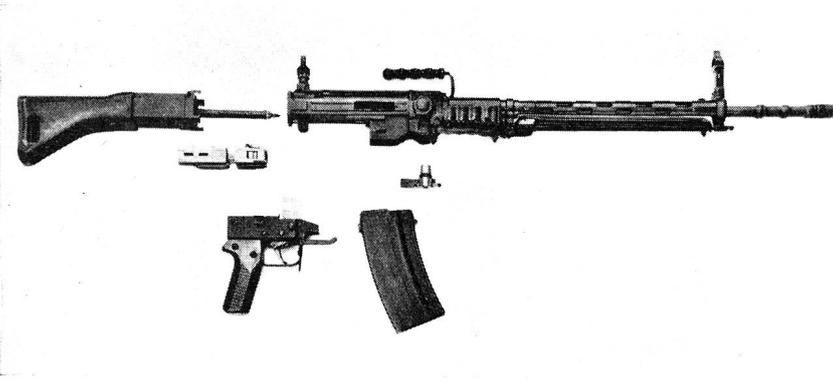
Fig. 6: Sturmgewehr in die Hauptbestandteile zerlegt
