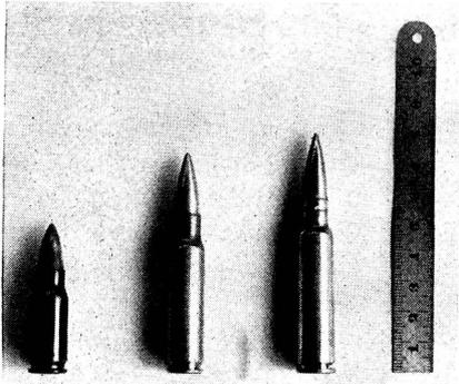
Fig. 3: Rechts die schweizerische Gewehrpatrone GP 11, Kaliber 7,5; in der Mitte die von den NATO-Staaten angenommene Munition Kaliber 7,62; links die verkürzte Mittelpatrone
