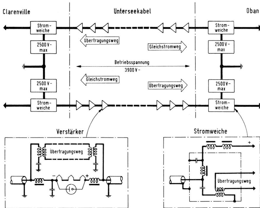
Fig. 4: Schema der Stromversorgung der Verstärker
