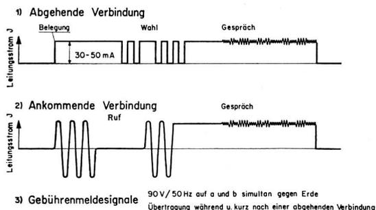
Fig. 5. Schematische Darstellung der zwischen Zentralen und Teilnehmer über eine Telephonleitung übertragenen Kriterien. Die drahtlose Anlage überträgt diese Kriterien mittels oberhalb des Sprachbandes liegenden Frequenzen.
