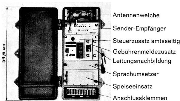
Fig. 4. Ansicht des amtsseitigen Anlageteils DTL 28 A einer drahtlosen Teilnehmeranlage für Fixverbindungen der Auto-phon AG. Interessant ist der Umstand, dass Sender und Empfänger volumenmässig nur einen kleinen Bruchteil der Gesamtanlage ausmachen. Das Gehäuse aus Gusseisen gestattet die Aufstellung der Anlage im Freien.
