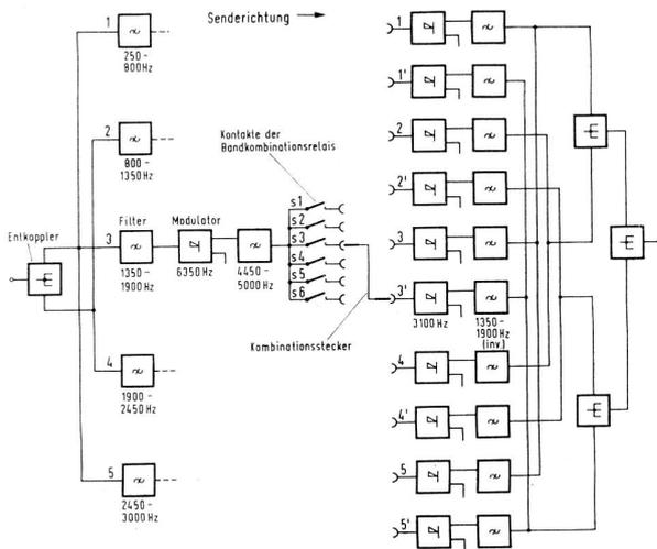
Fig. 4. Übersichts-Stromlaufplan der Sprachband-Umsetzung (Invertierung) in Senderichtung
