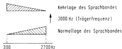
Fig. 2. Frequenzplan eines Sprachumkehrers
