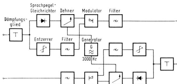
Fig. 3. Übersichts-Stromlaufplan eines verbesserten Sprachumkehrers
