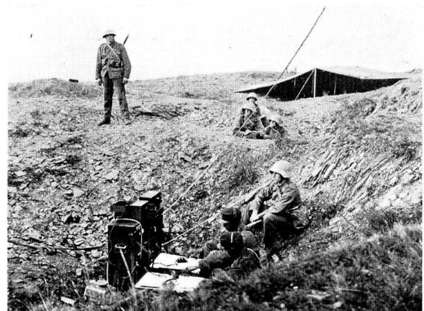
Abb. 34. Tragbare schwere Funkstation (TS) in Stellung.
