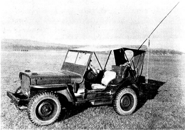
Abb. 44. Funkstation «Rex» in Jeep eingebaut, 1 Kanal, kristallgesteuert.
