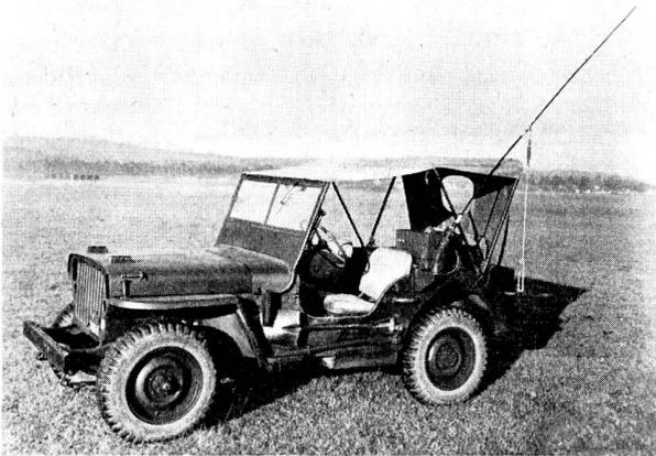
Abb. 44. Funkstation «Rex» in Jeep eingebaut, 1 Kanal, kristallgesteuert.
