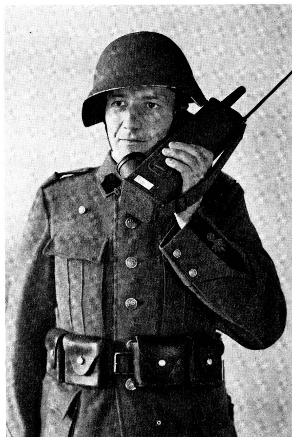
Abb. 43. Klein-Funkgerät «Handy talkie».
