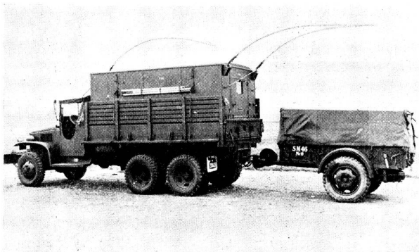
Abb. 41. Funkstation SM 46 auf geländegängigem Lastwagen montiert.
