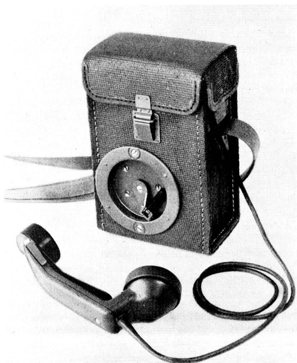
Abb. 42. Feldtelefon, Modell 50 (F. Tf. 50) für LB-Betrieb. Verwendung bei Leitungsbau und bei Fernbesprechung von Funkstationen.
