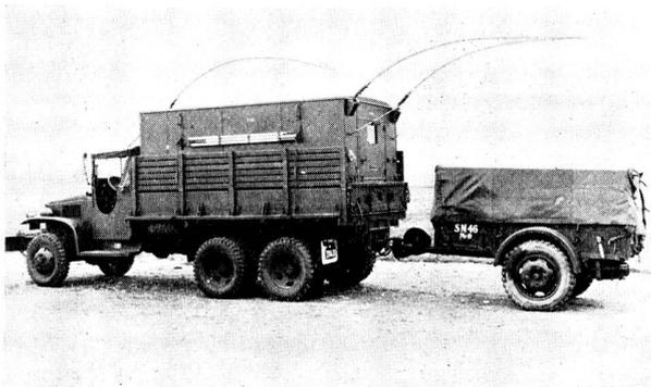
Abb. 41. Funkstation SM 46 auf geländegängigem Lastwagen montiert.
