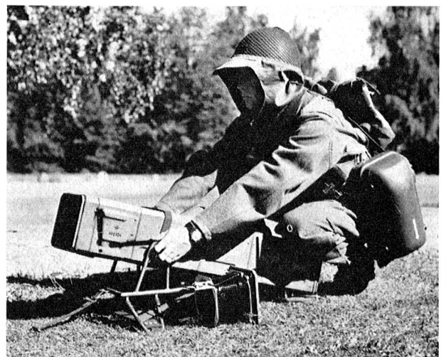
Das Einschalten des Systems erfolgt durch einige einfache Handgriffe in etwa 30 s, aus der Bewegung bis zum Schuss.
