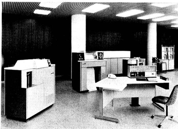
Der Computer vom Typ UNIVAC 1050, wie er in 152 Exemplaren von der amerikanischen Luftwaffe verwendet wird. Im Vordergrund die Bedienungskonsole, im Hintergrund von links nach rechts: Lochkartenstanzer, Formulardrucker, zentrale Recheneinheit, Lochkartenleser, 2 Magnetbandeinheiten.
