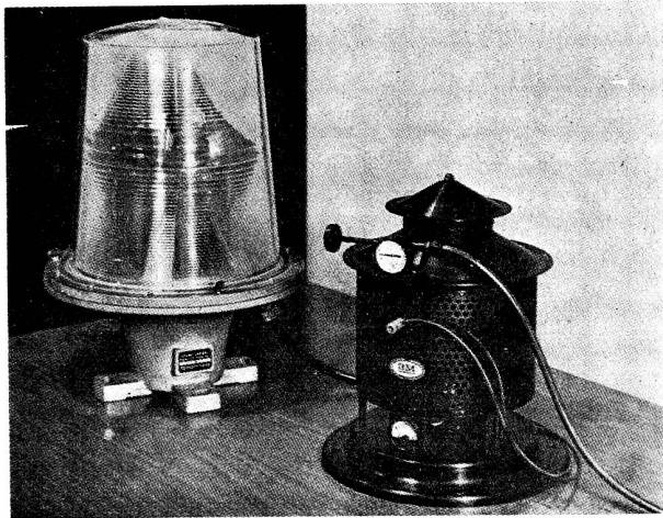
Fig. 14. Thermoelektrischer Generator (ohne Tank und Regelungseinrichtung für Brennstoff) für die Stromversorgung einer Leuchtboje. Max. 12 V, 3 A. Durchschnittliche Leistung 5 W. \eta = 2,4\% (Minnesota Mining & Manufacturing Comp.).
