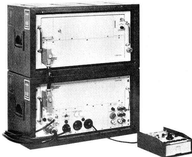
Das Gretag-System TC-534 umfasst automatische Uebersmittlungs- und Chiffriergeräte für die Geheimübertragung von Fernschreibnachrichten über Funk-, Telex- oder Telefonverbindungen.
