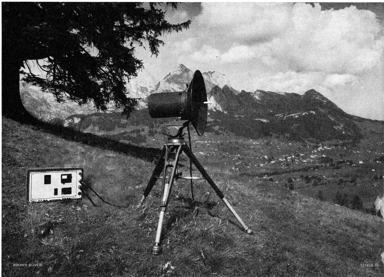
Modernes Richtstrahlende-/Empfangsgerät für Mehrkanalübertragung im Frequenzband 6400...8000 MHz
