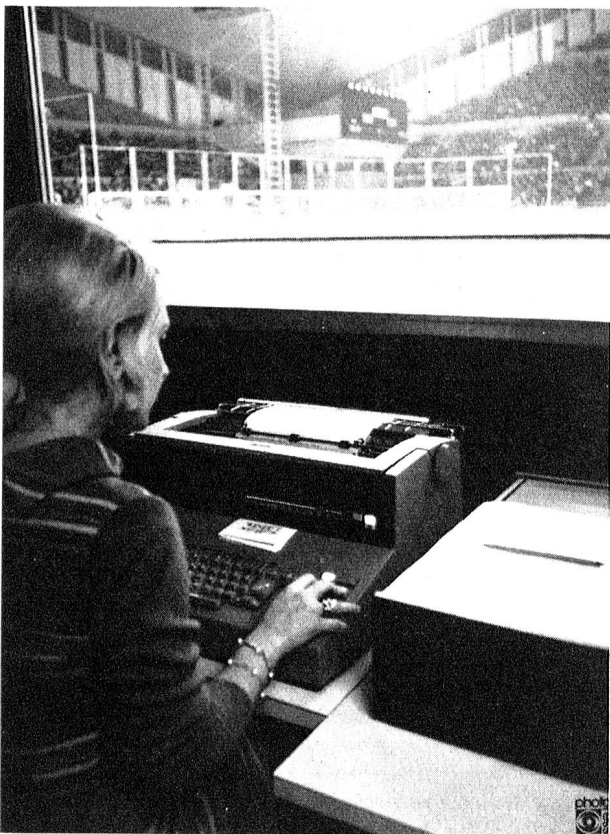
Eine Ein-/Ausgabestation im Eisstadion Grenoble. Während der olympischen Wettkämpfe wird die Verbindung dieses Terminals über Telefonleitung mit dem Computer im Rechenzentrum nie unterbrochen.
