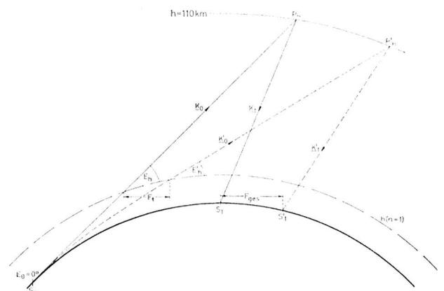
Fig. 14 Querschnitt durch die Erde mit der Geometrie des Strahlenganges in vertikaler Richtung für UKW-Polarlicht-Funkverbindungen von  $S_0$  über  $P'_1$  nach  $S'_1$  im Falle der Krümmung des Ausbreitungsweges in der unteren Atmosphäre (Troposphäre).  $F_{ges}$  = Vergrößerung der Reichweite durch radio-meteorologische Einflüsse. Erklärung der anderen Abkürzungen siehe Text Fig. 3. Nach [6].
