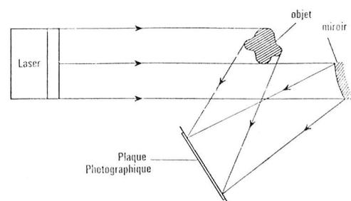
Fig. 14: Enregistrement d'un hologramme
