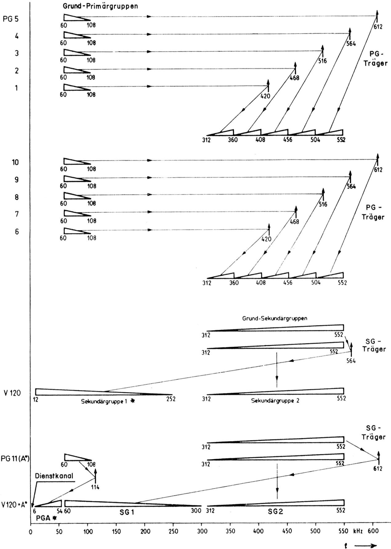
Fig. 2: Frequenzplan TF-Umsetzgerät 60/120-Kanal — V 60/120 —
