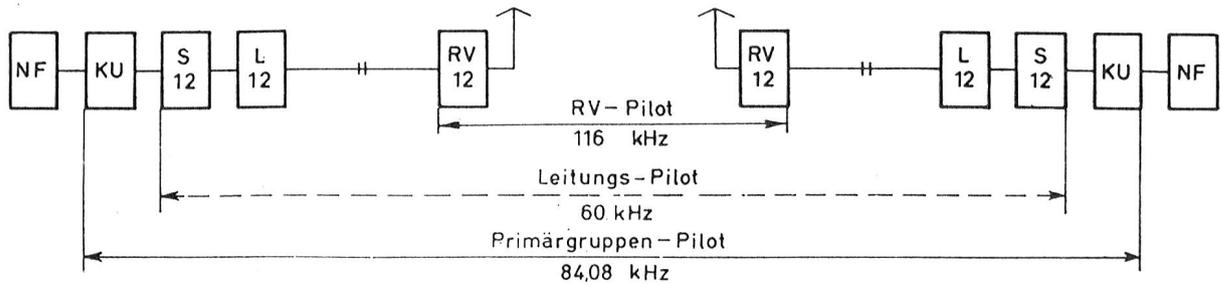
2. Pilote einer 120-Kanal-Verbindung
